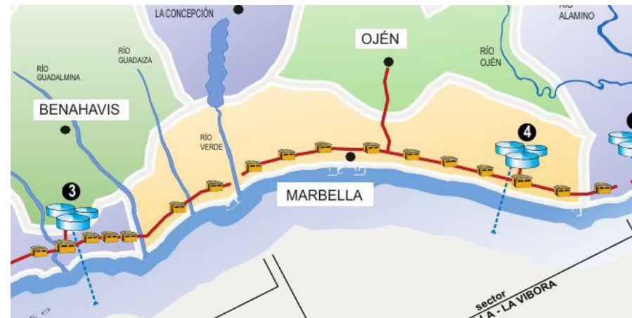
Figura 89: Esquema de colectores y EDARs Marbella Fuente: ACOSOL
