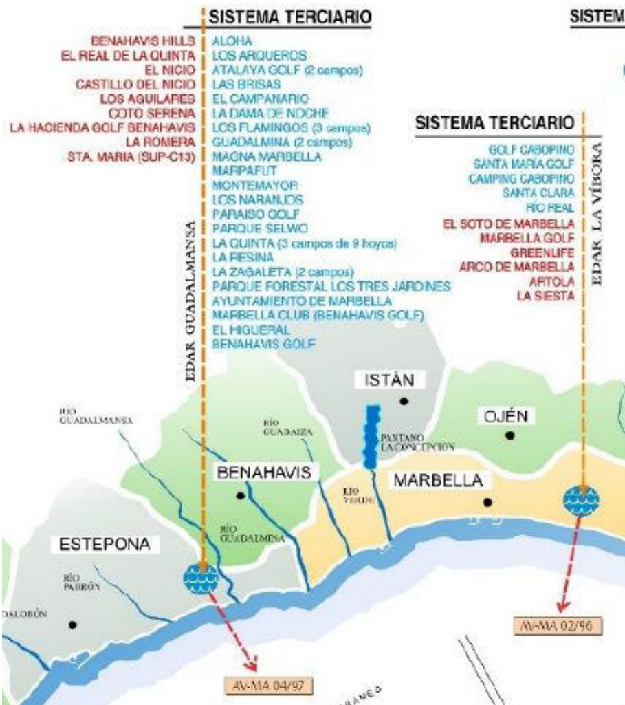
Figura 91: Esquema abastecimiento agua regenerada Fuente: ACOSOL
