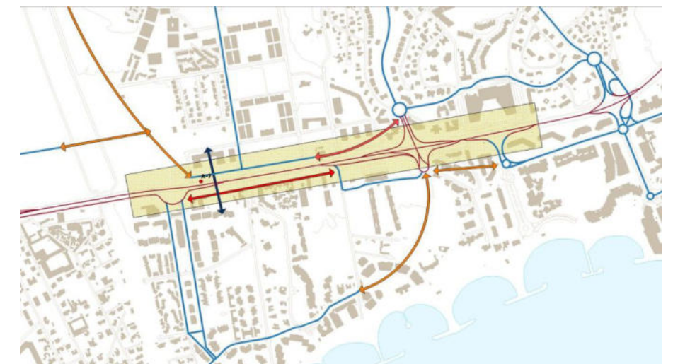
Figura 81: Tramo conflictivo de la A-7 con solapamiento funcional de movimientos y de accesos directos urbanos entre enlaces, con déficits de conectividad y vas de servicio. Es necesaria una adecuada articulación entre movilidad y accesibilidad
